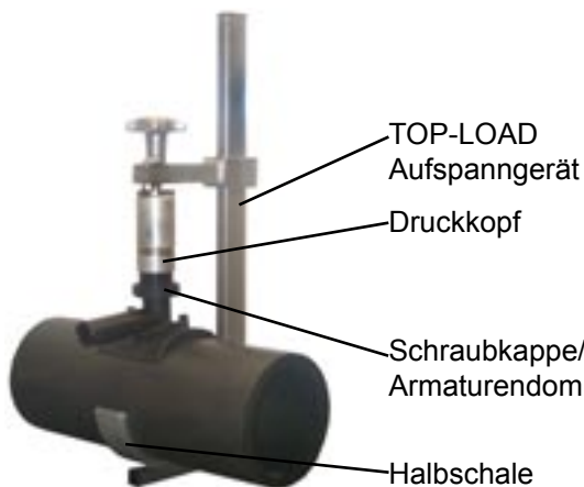
Abbildung zeigt TOP-LOAD Aufspanngerät mit diversen Halbschalen, die nicht im Lieferumfang enthalten sind.
