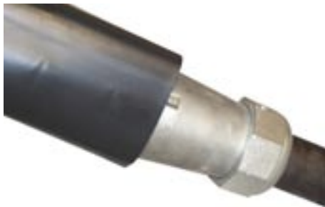
1 Schrumpfschlauch bzw. -muffe überschieben.
