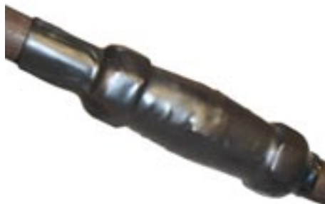
3 Vor mechanischer Belastung den umgeschumpften Gegenstand auf ca. 30°C (handwarm) abkühlen lassen.
